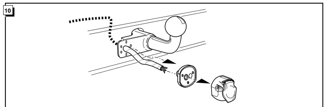
**INFO** Anschluß Steckdose / Connection de la prise / Socket connection / Contactdoos aansluiting
